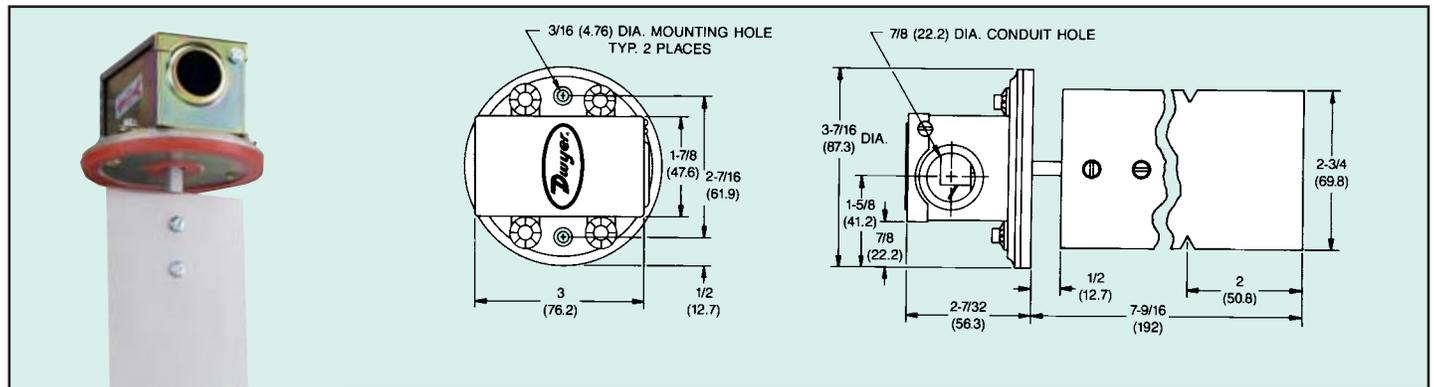
型号 530 空气流量开关灵敏度高，可靠性高，价格合理。特点为坚固的压铸主体，不锈钢叶片，单刀双掷快速开关。其现场可调整从 400 到 1600 FPM。安装快速简单，只需两个螺钉。叶片适用于 6 英寸或更大的管道中。
