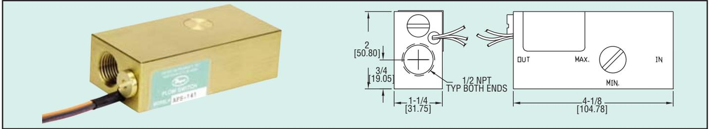
AFS 系列可调流量开关可从外部进行调整，适于在冷却液流量中断时保护机械设备，在无润滑油时保护轴承，或者保证合适的空气流量。AFS 系列可任意设置设定值范围从 0.5 到 20GPM（压力高达 1000 psig），并且压降小，重复性高。AFS 封装在黄铜或不锈钢中，可用于水、兼容性液体、油和气体中。
