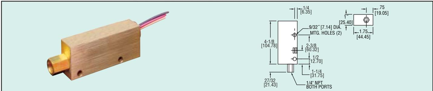
P1 系列黄铜流量开关利用活塞式设计精确地检测过多或不足的流量。活塞靠磁力动作密封的单刀双掷簧片开关，开关的预设动作点为 0.10 - 1.5 GPM (液体流速)。P1 系列很适合保护液压系统的断流，也用于半导体工业中保证适当的冷却液流量。
