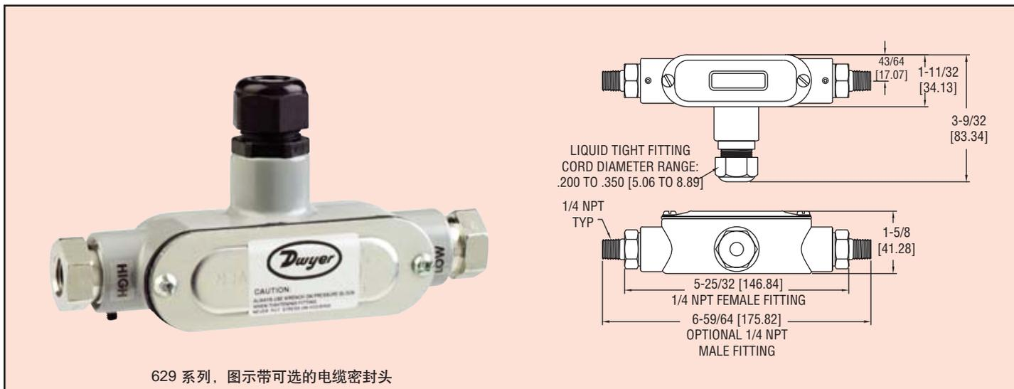
德威尔 629 系列差压变送器可监测空气和兼容气体和液体的差压，具有 0.5% 精度。设计应用双压力传感器将压力转变成标准 4-20 mA 输出信号，用于两线回路。内部小的移动空间和小的部件移动确保了快速的响应和稳定性能。接线盒，零位和量程打开上盖就能调整。629 系列差压变送器设计达到 NEMA-4X (IP66) 构造要求。
